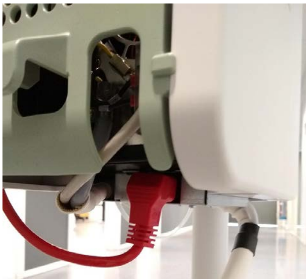
Obrázek 15-2. Napájecí zásuvka a napájecí kabel v systému s baterií.
