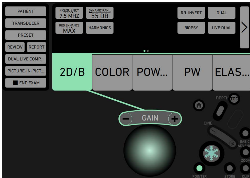
Obrázek 3-14. V základním zobrazení jsou režimy k dispozici jako velká tlačítka umístěná pod oblastí parametrů.
