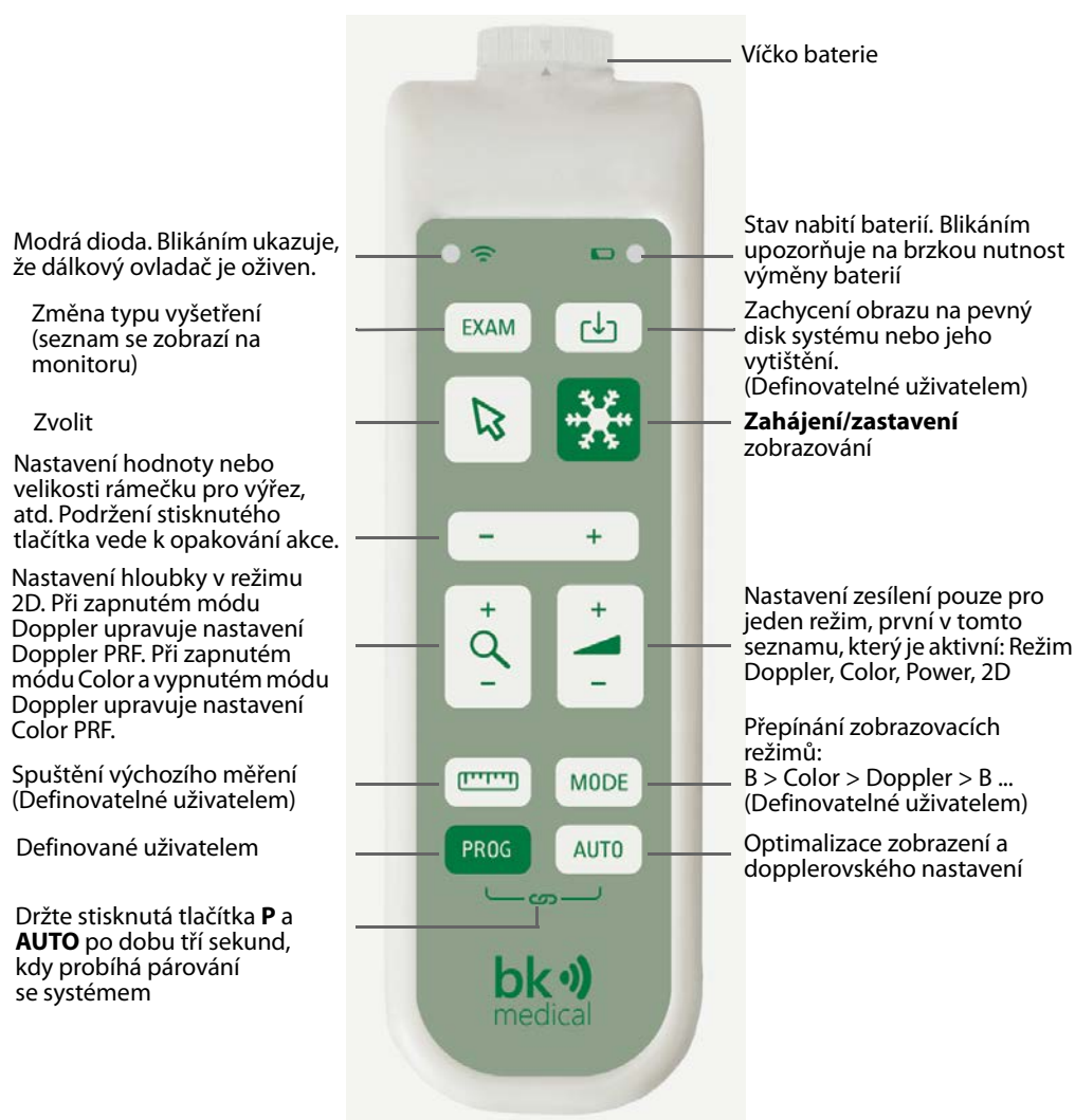
Obrázek 17-1. Dálkový ovladač a umístění jeho různých ovládacích funkcí.
