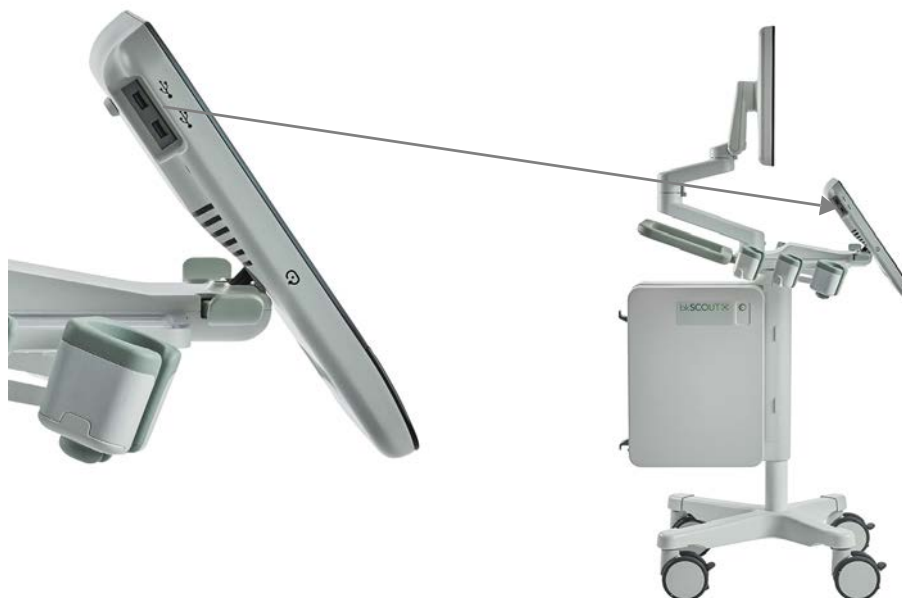
Obrázek 15-6. Konektory USB (1 a 2) na dotykové obrazovce. Pokud chcete připojit mechaniku CD/DVD, můžete to učinit zde.
