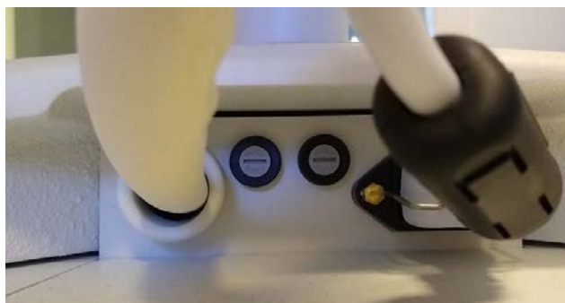
Obrázek 15-3. Pojistky v přihrádce na baterie.
